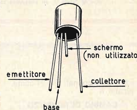
Fig. 5 - Il transistor TR1, che è di tipo AF115, è munito di quattro terminali; il quarto terminale è rappresentato dallo schermo che deve essere tranciato ad una certa distanza dal componente allo scopo di evitare falsi contatti.
